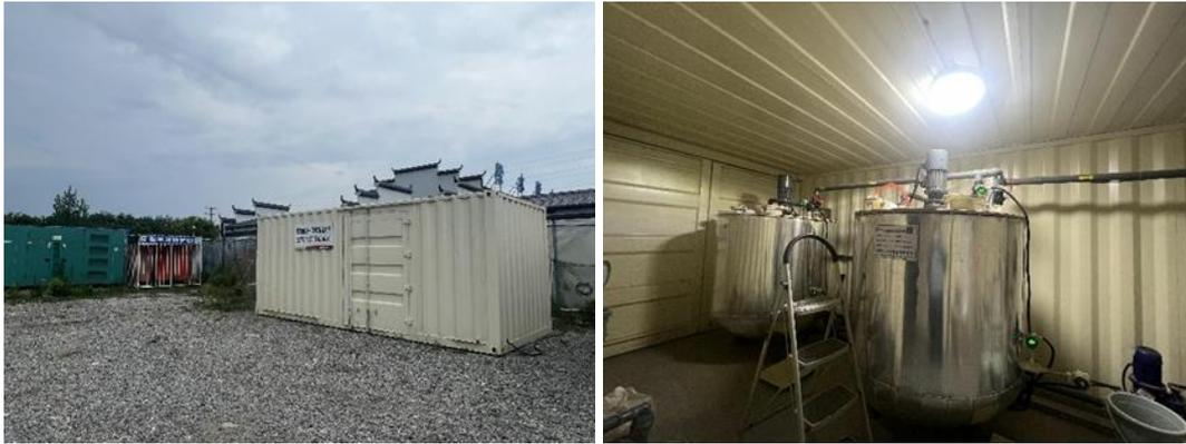
图1 安徽某焦化场地泥浆生物反应器中试设备照片
