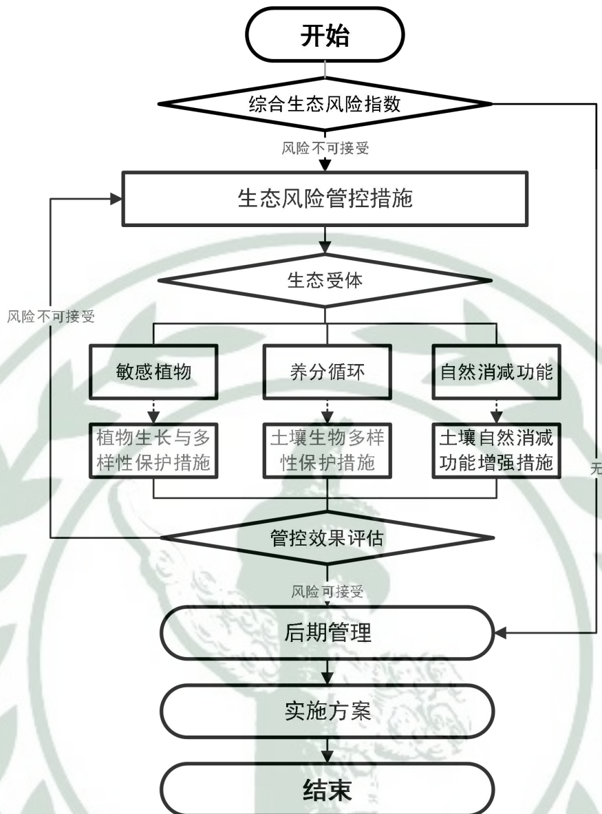
图 1 重金属污染场地生态风险管控的工作流程图
